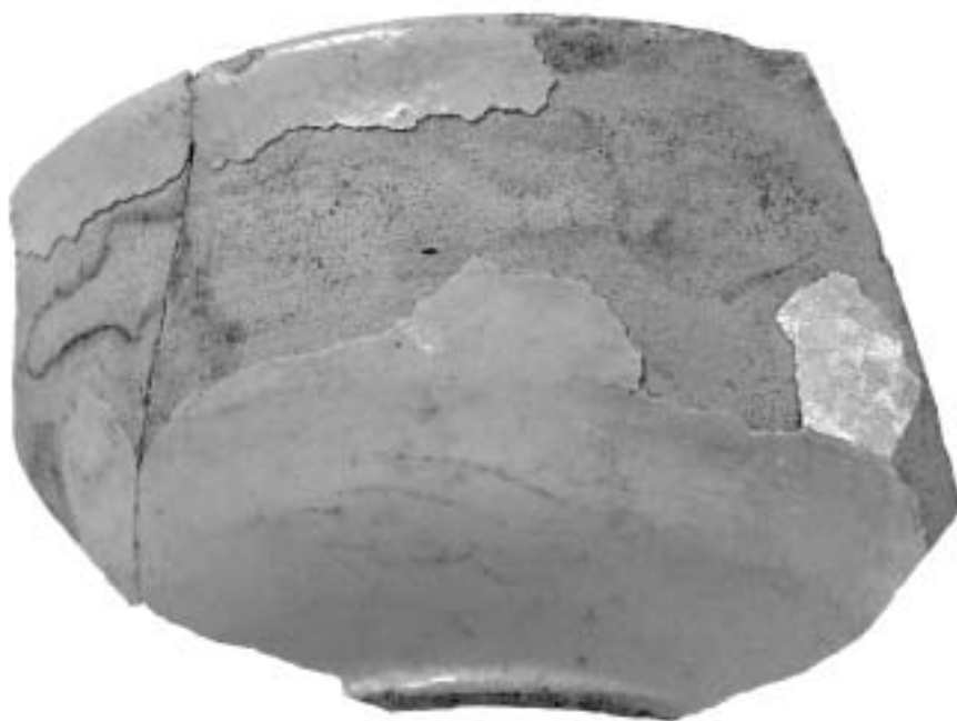
Fig. 10 Exemplo do destacamento amplo do esmalte, em que a cobertura esmaltada se destaca da chacota em grandes placas uniformes.
