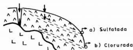
Fig. 15.—Esquema sobre los diferentes tipos de manantiales en el diapiro de Pinoso.
