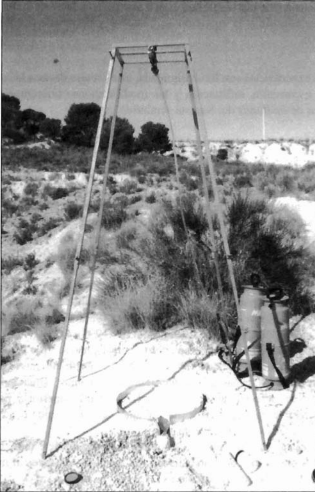
FIGURA 1. La lluvia simulada es una de las técnicas más utilizadas y de mayor fiabilidad para cuantificar tasas de infiltración, escorrentía y producción de sedimentos. En la figura, simulador de lluvia y equipo de presurización manual por aire comprimido, al iniciarse uno de los experimentos sobre suelo desnudo. Campo experimental de "Los Guillemos".
