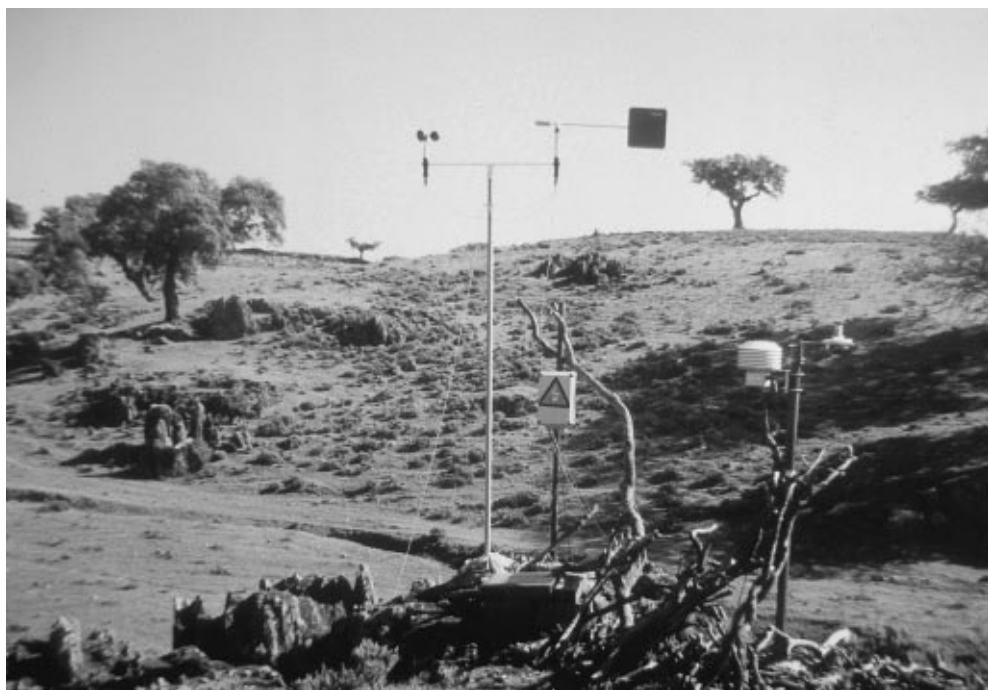
Foto 4: Estación meteorológica: sensores de temperatura, humedad relativa del aire, radiación solar, dirección (veleta) y velocidad del viento.
