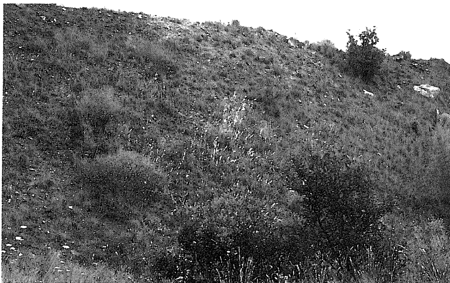
Fotografía 3: Estado de la vegetación, en la primavera de 1995, de un talud cubierto en 1986 con suelo de la zona (tierra vegetal), previamente retirado y conservado.
