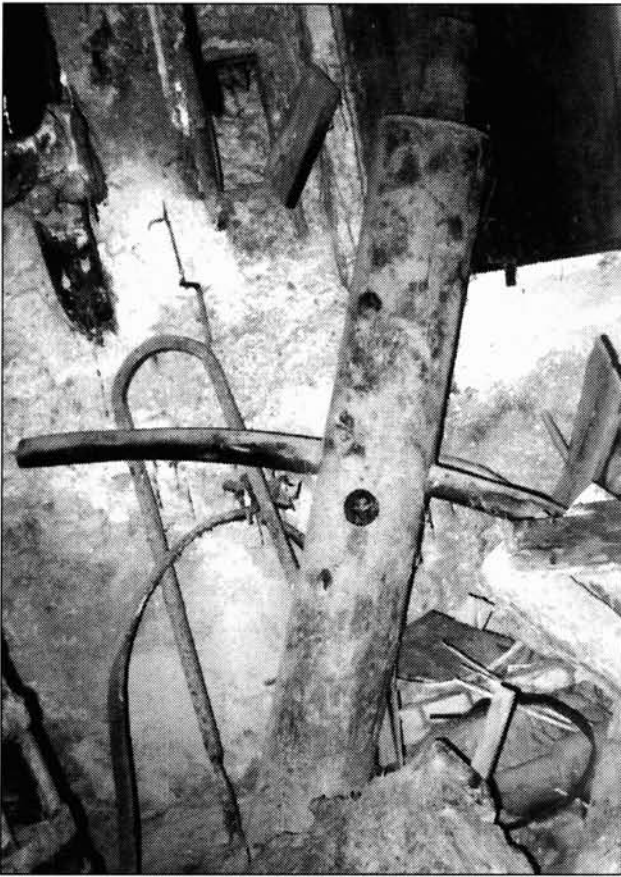
FOTOGRAFÍA 14. El llamado «burro» o madera giratoria a la que se enrollaba la tuerca que al ir enroscándose hacía presión tirando para atornillar la cabeza de una de las prensas de vino de la almazara.
