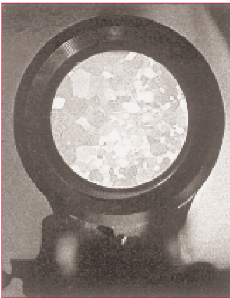
A estrutura microcristalina do aluminio maniféstase coa luz polarizada.
