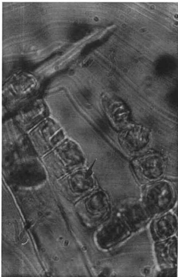
Fig 6: Micrografía a 200 aumentos de un fragmento de fibra de corteza de Betula sp. Caracterizada por la presencia de gránulos de Betulina. (Usada como patrón comparativo).
