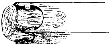
Fig. 4.—Cabeza de jácena que sirve de can en el alero del tejado.
