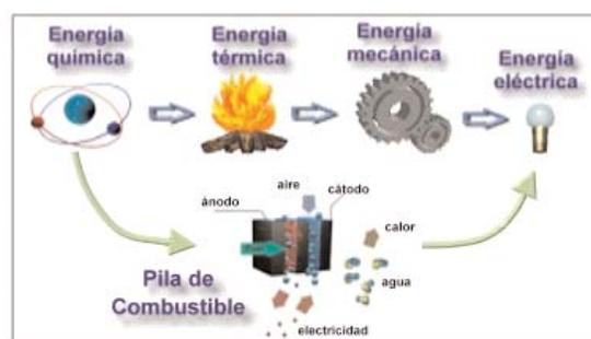
Figura 5. Esquema mostrando la transformaci n de la energ a qu mica en el ctrica, por medio de los procesos tradicionales de generaci n el ctrica y por medio de una pila de combustible.
