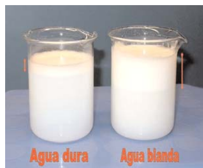
Figura 4. Acción de la dureza del agua en el efecto espumante de un jabón.
