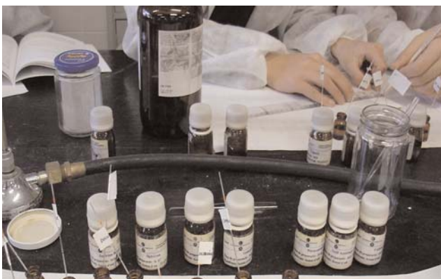
Figura 6. Identificación de analgésicos: soluciones patrón y muestras a caracterizar por cromatografía de capa fina.
