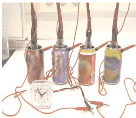
Figura 7. Se puede poner en marcha un despertador si se conectan en serie cuatro de las pilas construidas
