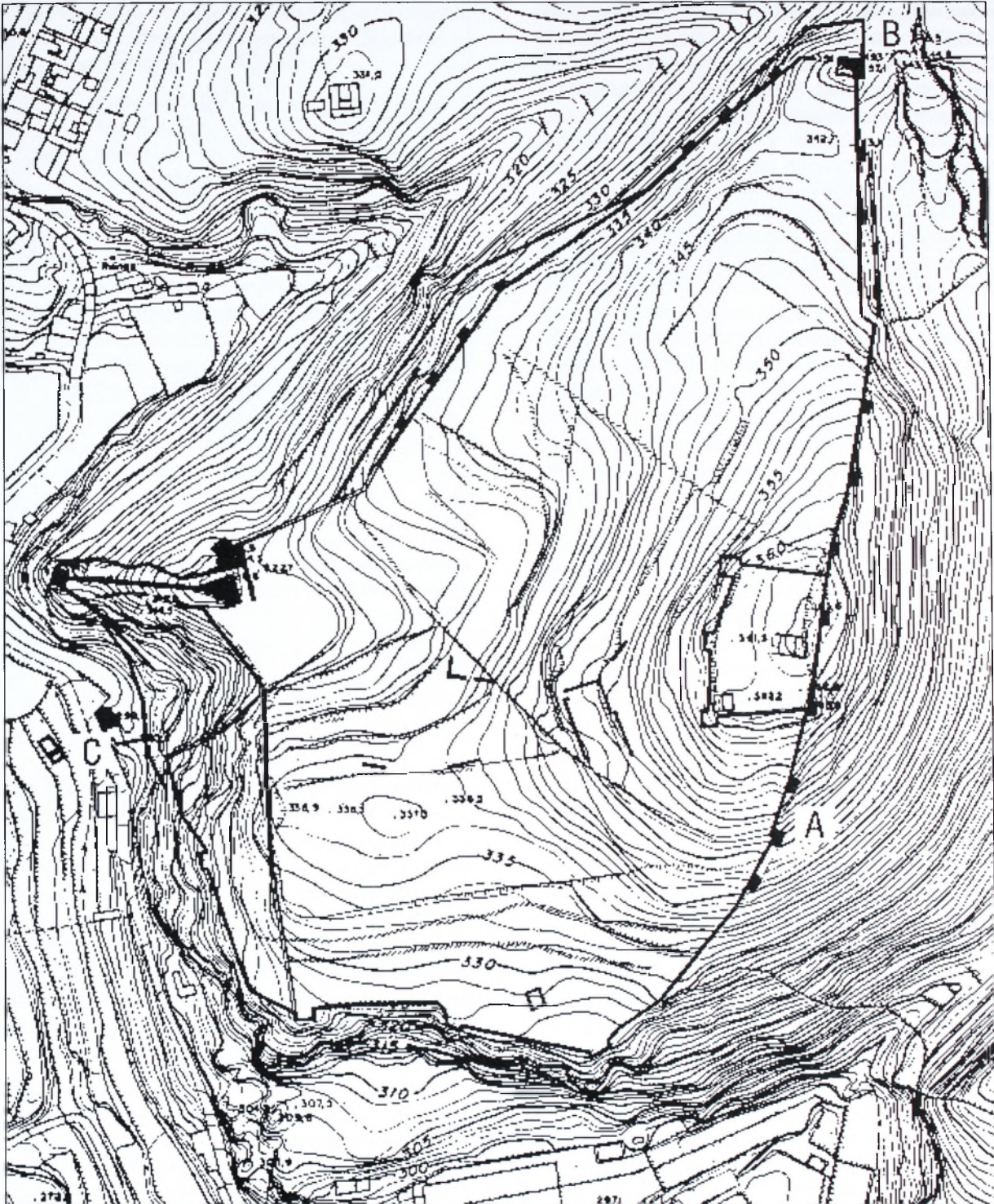
Fig. 3. Planta de Villavieja. A) Paño de muralla actualmente conservado. B) Torreón del extremo septentrional. C) Torre poligonal que protege el acceso a la Fuente de la Rana. Obsérvese la ciudadela o pequeña alcazaba donde hay dos grupos de aljibes.
