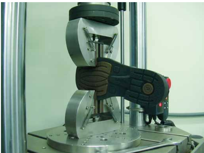
Figura 1. Ensayo a tracción del sistema "adaptaction".
