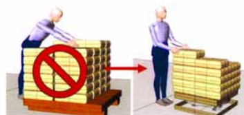
Figura 2 - Diseño ergonómico: rediseño del equipo de trabajo para facilitar los alcances
