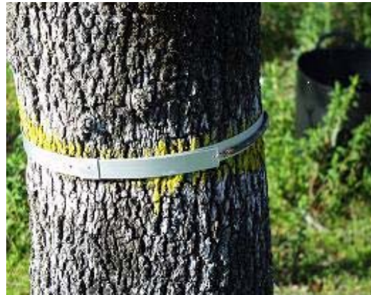
Foto1. Dendrómetros de banda colocados en las encinas para medir el crecimiento diametral
