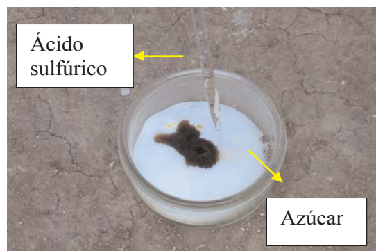
Figura 3: Inicio reacción de carbonización.
