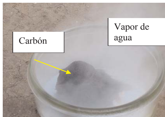
Figura 4: Reacción de carbonización.
