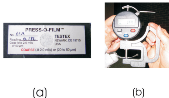
Figura 4. Dispositivo utilizado para la determinación de la rugosidad superficial. (a) Cinta calibrada sensible a la presión. (b) Micrómetro digital para medición de las cintas.
