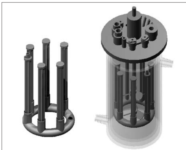
Figura 1. Módulo interno de filtración en acero inoxidable.
