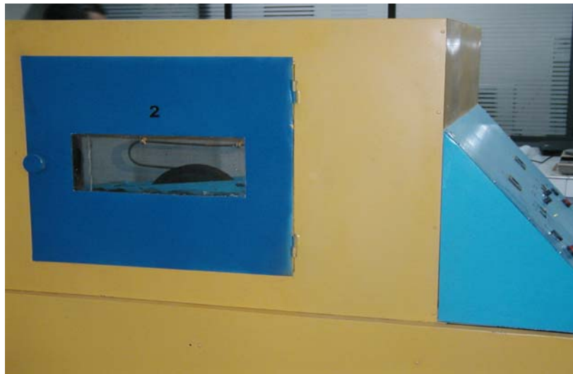
Figura 4. Ahuellador para el ensayo de pista
