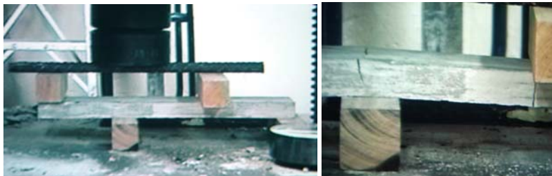
Figura 8. Montaje y ensayos de pequeñas vigas de mortero reforzado
