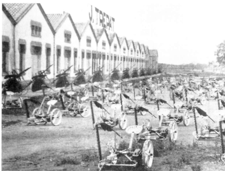
La fàbrica de maquinària de Josep Trepat i Galceran. Les màquines alineades davant de la fàbrica són les cèlebres segadores Trepat que van donar a aquesta firma la seva fama. Aquesta empresa és el símbol de la industrialització targarina. (Fotografia: Jaume Calafell).
