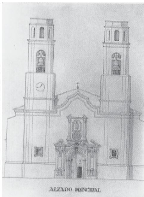
(Fig. 33) Alçat de la façana principal amb les dues torres.
