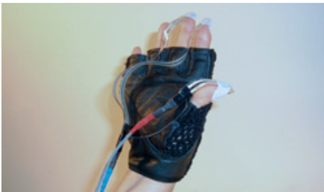
Figura 1. Imagen del marcador reflectante para el sistema de fotogrametría (arriba) y colocación de los sensores de presión resistivos utilizados (abajo).
