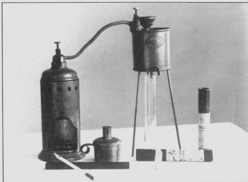
Alambique "DUJARDIN-SALLERON" adoptado por el Ministerio de Fomento de España para los 30 Laboratorios Agrícolas creados por la Ley de 9 de Mayo de 1908. Abajo, aparato para obtención de "YOGHOURT", marca Bulgaria (pieza numerada).
