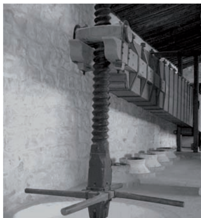
Foto 4. Prensa de viga y quintal. Sistema de regulación de peso
