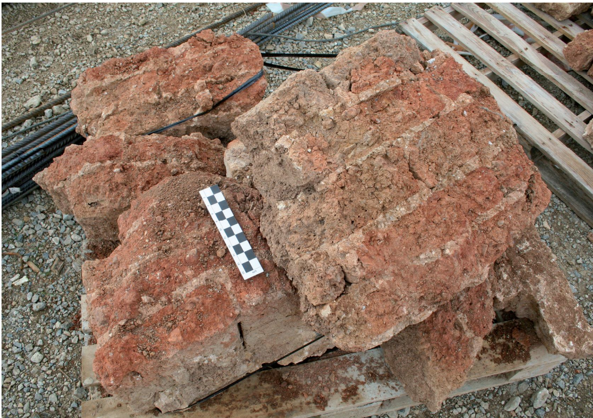
Lám. 9: Horno de cal. Fragmentos de pared de adobes pertenecientes al alzado de la cámara de calcinación que, en origen, recreían la pared tallada en la roca que constituye la parte inferior de la misma.
