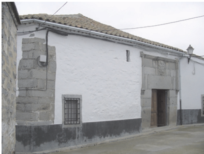
Ejemplo de utilización del sillar de granito en esquinas y portada de una vivienda de Dos Torres.
