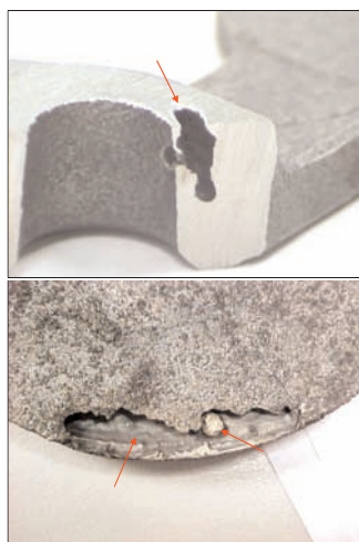
Figura 14. Diferentes tipos de sopladuras en piezas fabricadas con fundici n grafitica laminar.
