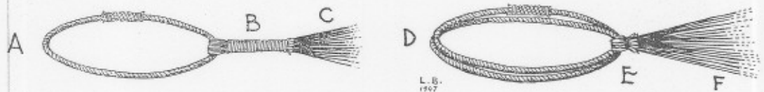
Arte de sardinal. —A: puño de la pieza de arrastre, con su amarre, B y las 13 colas, C; D: puño de la pieza de la mano, con su amarre, E y las 15 colas, F.
