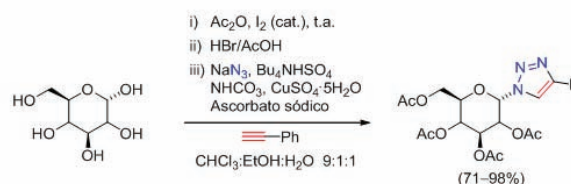
Figura 10. Síntesis de triazol-glicósidos en un solo paso.
