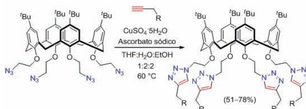
Figura 4. Cicloadiación de alquinos sobre calixarenos-azidas catalizada por Cu(I) generado in situ por reducción de Cu(II).
