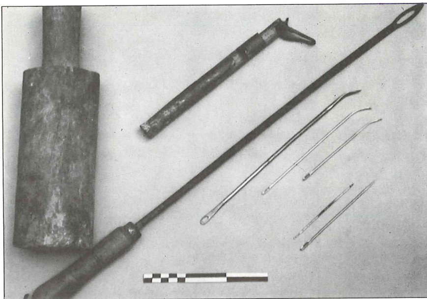
Maza para majar esparto y diversos tipos de agujas empleadas en las distintas clases de cosido. La caña es el canillero que sirve, en este caso, para guardar las agujas pequeñas. (Fotog. 4).
