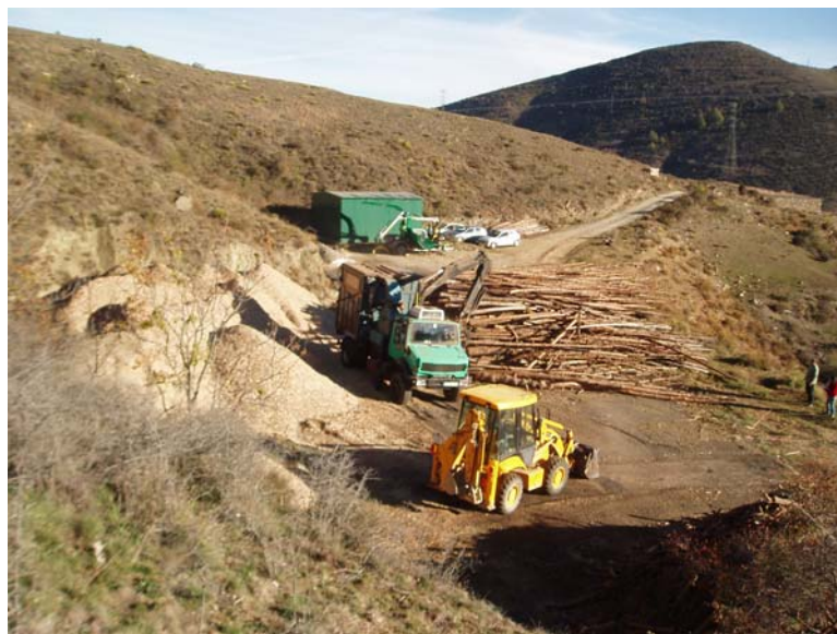
Figura 3: Astillado en patio, disposición del material bruto y pilas provisionales
