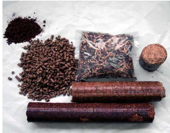
Gráfico 1.- Diferentes tipos de briquetas y pelets
