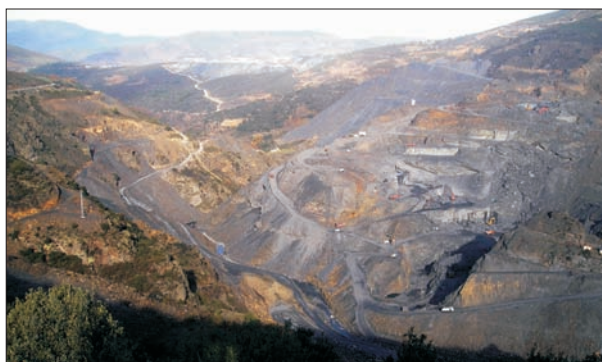
FIG. 4. Explotación de pizarra en el valle del río Casaio. Los filones de pizarra que se explotan con intensidad desde 1970 hasta la actualidad en la zona de Castañeiro (municipio de Carballeda de Valdeorras-Ourense), avanzan por la margen derecha del río Casaio. La disposición de los depósitos de pizarra y las escombreras han obligado a cambiar el trazado del río. Los estériles resultantes (98% de la extracción) se extienden por toda la ladera. Esta área minera ha sido una de las que se han elegido para comenzar con las labores de restauración de este paisaje tan degradado.
