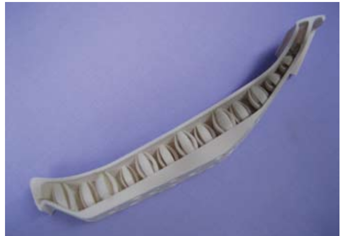
Figura 4. Sección del prototipo de asiento fabricado como demostrador del proyecto.
