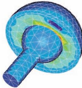
Figura 7. Modelo de una copa acetabular y componente femoral.
