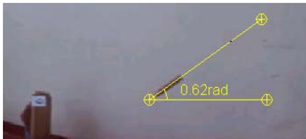
FIGURA 2. Medición del ángulo de giro, mediante el programa Data video de Coach 5 [7]. Los cambios se determinan avanzando la película cuadro por cuadro.
