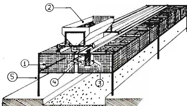
Dinámico y emprendedor fabricante de material, que presentó junto a modelos de jaula maternal con un gran nidal exterior y jaula de selección, una interesante vagoneta-tolva (o cono auxiliar), que situada en un rail sobre las jaulas de engorde, facilita la alimentación semi-automática. Esta vagoneta de desplazamiento manual o mecánico lleva unos dispositivos de dosificación de pienso.
