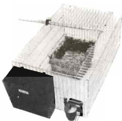
Entre un completo y muy surtido material, con algunas mejoras técnicas (sistema perforado para sujeción de tolvas, bebederos, suelo de nidal plástico, etc.), debemos destacar la jaula "Lorton-super" con nido, en donde en la ya reconocida jaula Lorton acondiciona un nidal hundido aislado mediante el sistema de sandwich (paja entre castillo y paredes / suelo de la jaula). Este nido es móvil, dando una gran versabilidad a la jaula.
