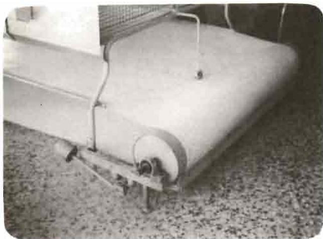
Constructor de sólido material, presentó una completa gama de jaulas, tanto de tipo industrial como familiar. Debemos destacar como novedad un tapiz plástico móvil, que situado debajo de las jaulas, sobre suelo liso, permite mediante un sistema de grandes rodillos la limpieza automática. El costo del sistema parece ser equivalente al scrapper (pala mecánica).
