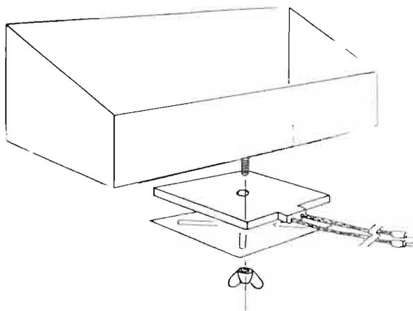
En caucho, trabajando a muy baja temperatura, fácil montaje, por debajo y al exterior del nido, con un solo tornillo, siendo posible cambiarlo a otros nidos.
