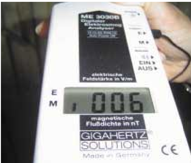
5. Medición del campo electromagnético en la zona de colocación del catalizador.
