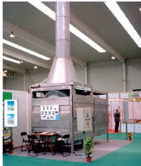
Incineradora de residuos
