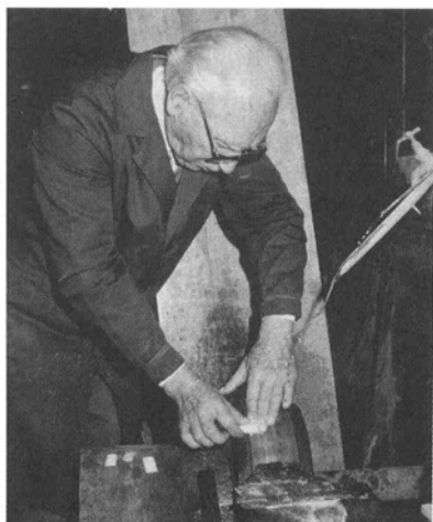
Fig. 9. El cuchillero de Sástago pule las piezas de nácar de M. auricularia en la piedra de agua. Foto: Archivo Eugenio Monesma, 1991; reproducción autorizada.
