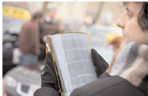
Figura 10. Prototipo de Plastic Logic de un libro basado en papel electrónico. Publicado con el permiso de Plastic Logic.
