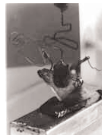
Figura 1. Primer transistor de Ge inventado en 1947 por Bardeen, Shockley y Brattain. Cortesía de Lucent Technologies Bell Laboratories .
