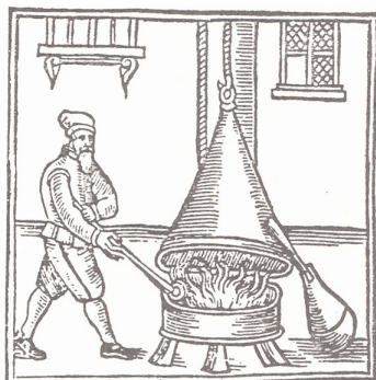
Figura 3. En el llamado "método de campana" para la fabricación de ácido sulfúrico, el azufre se quema bajo una campana, en presencia de pequeñas cantidades de salitre. Los gases de \text{SO}_2 se recogían en el recipiente receptor de la derecha, llenado con agua. Fuente: The Art of Distillation, or a Treatise of the Choicest Spagyricall Preparations performed by the way of distillation , London, 1651.
