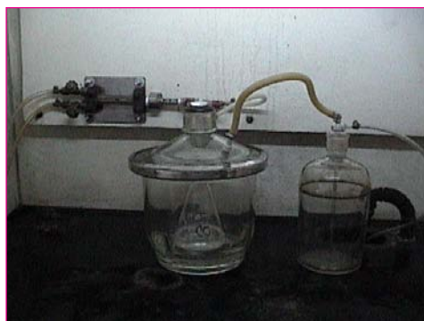
Montaje para el crecimiento de las bacterias carboxidótrofas nativas
