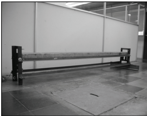
Figura 11. Configuración experimental para efectuar saltos de vibración forzada en laboratorio
