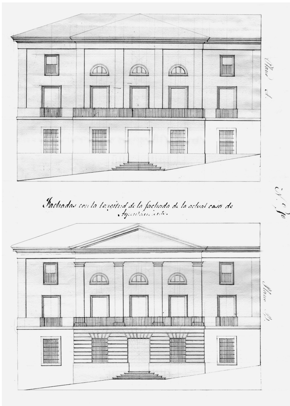
FIG. 1. Diseño de dos proyectos de fachada para la reedificación del Ayuntamiento en su antiguo emplazamiento, realizados por el Arquitecto Municipal Antonio Jiménez (A.H.M.C.).
