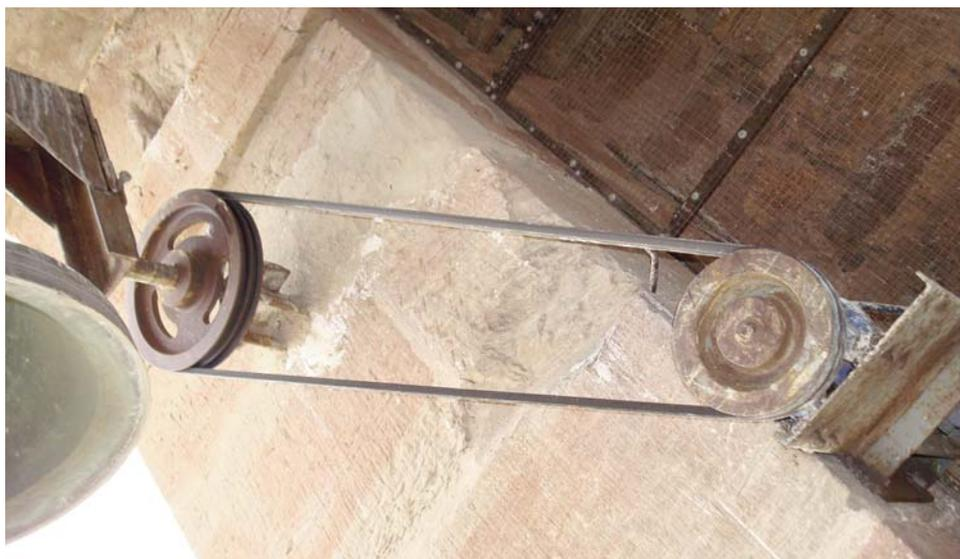
**Fig. 6:** Sistema eléctrico de polea para el volteo en *Doña Sara López* (Torre de Juan Abad).
