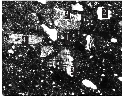
Figura 40. Material intersticial (1) que engloba granos de desgrasante de cuarzo (2), feldespato (3) y fragmentos de roca metamórfica (4).
