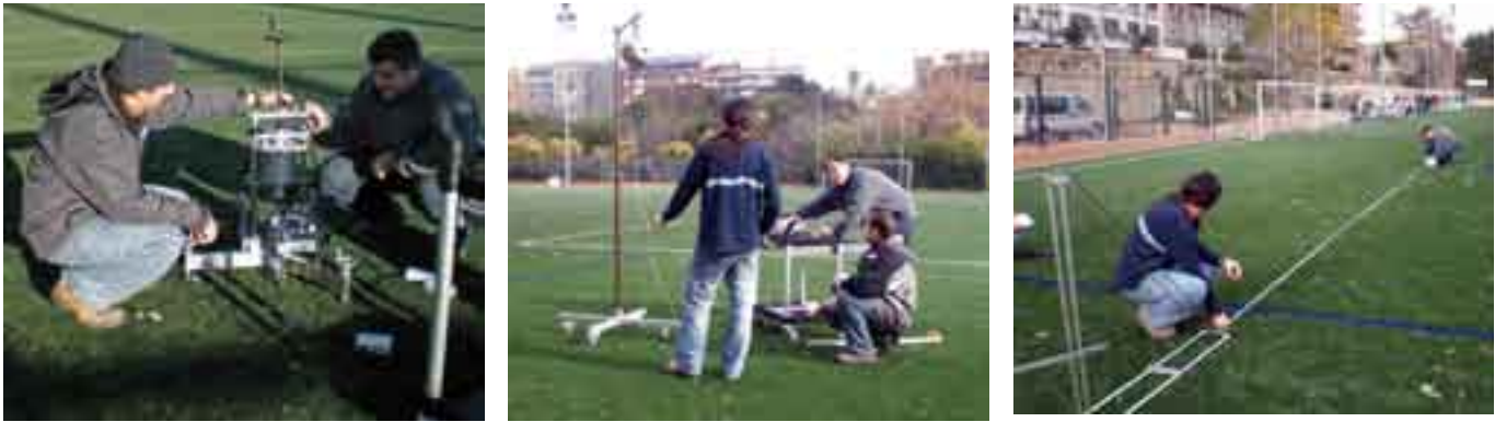
Figura 1. Ensayos para la evaluación de las propiedades del césped artificial: a) amortiguación de impactos (relacionado con la interacción jugador-superficie); b) y c) bote vertical y rodadura de balón respectivamente (relacionados con la espectacularidad en el juego).
